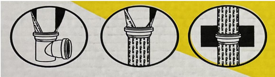
Začněte instalaci ze spodní části potrubí.
