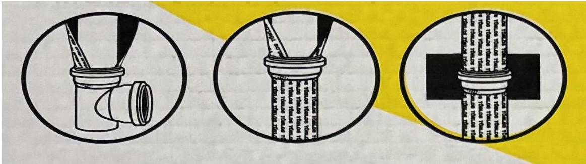
Beginnen Sie mit der Installation an der unteren Rohrmuffe.
