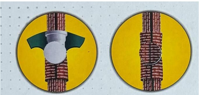
Paigaldage ettevalmistatud liitmikuosa.
